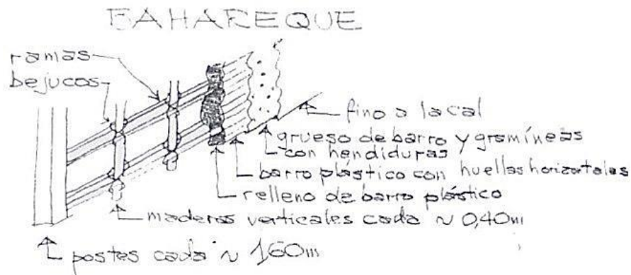
Gráfico 8. Dibujo de un detalle técnico constructivo. Incluye el epígrafe: “Detalle del sistema de entramado con barro”.
