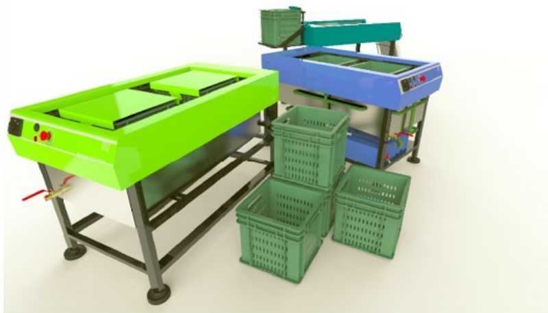
Figura 1. Máquina lavadora de hortalizas destinada a cooperativas de Agricultores Familiares desarrollada por el diseñador industrial Matías Novelli.
