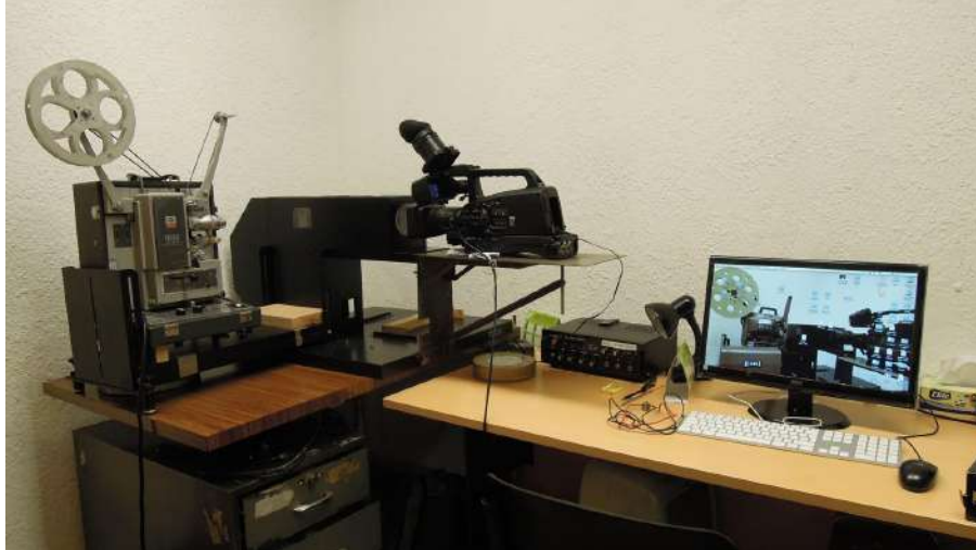
Fig. 1. Sistema de telecine usado por el LAPA hasta el 2016 (Foto: LAPA)
