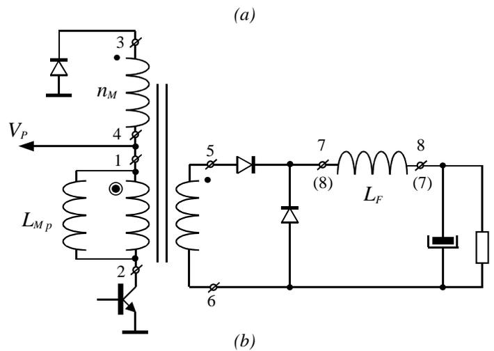
Fig. 9 : Convertidor forward magnéticamente integrado desacoplando bobinados, (a) detalle del circuito magnético, (b) circuito eléctrico equivalente.
