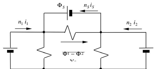
Fig. 5 : Circuito eléctrico equivalente  $\pi$  en la analogía de permeancias (obtenido por aplicación de las reglas de dualidad).
