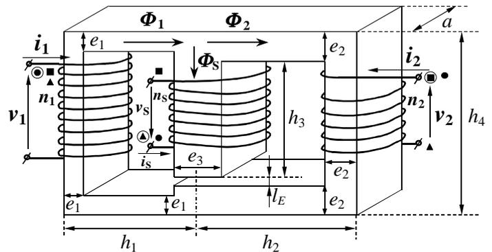
Fig. 1 : Núcleo con derivación de flujo magnético.
