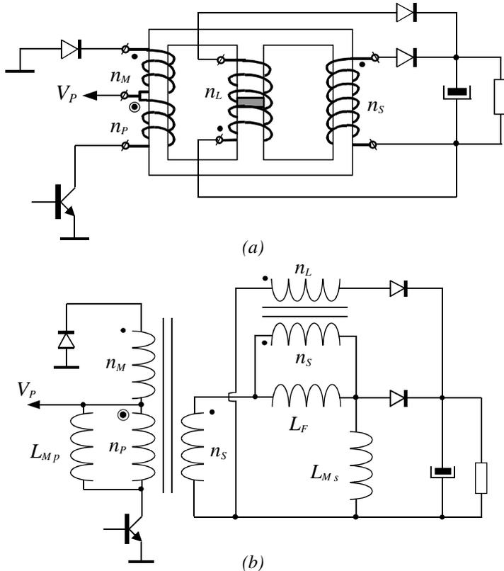
Fig. 8 : Convertidor forward magnéticamente integrado aprovechando el circuito equivalente, (a) detalle del circuito magnético, (b) circuito eléctrico equivalente.
