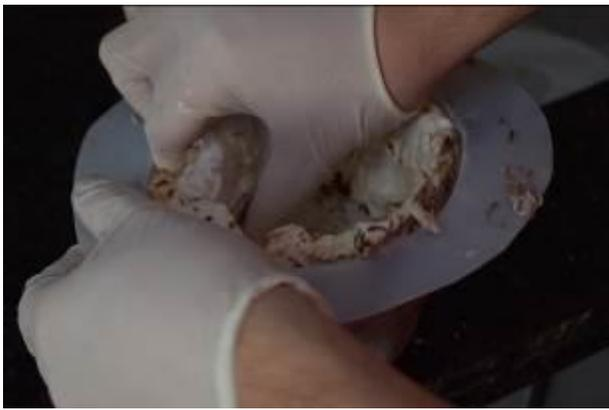
*Figura 5. Desmolde del material colonizado.*
