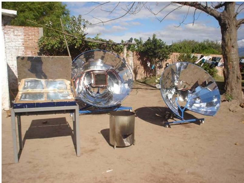
*Fig. 1. Kit solar para cocción de alimentos*
