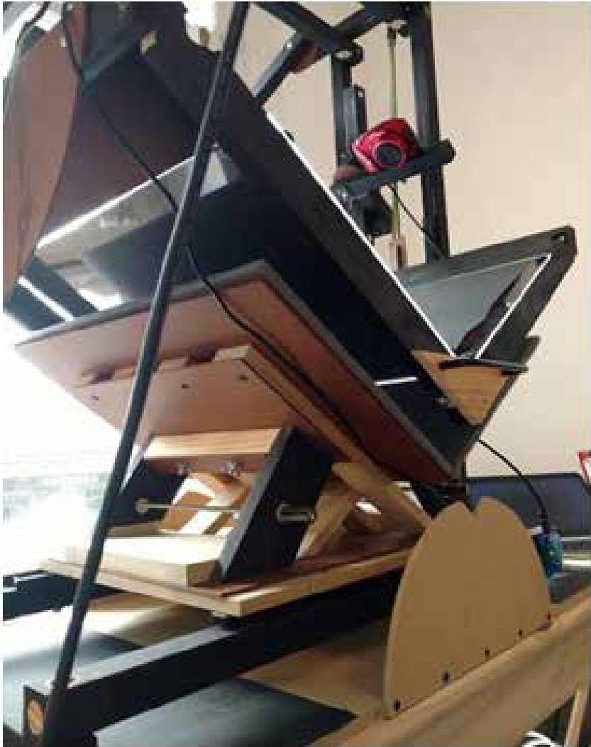
Figura 2. Vista de la plataforma móvil del escáner y de su cuna con forma de V.
