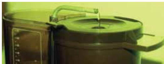
Fig. 7 - Movimento da água pelo tubo após aquecida
