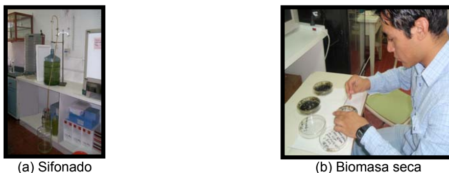
Figura 2. Separación de la biomasa por sifonado y obtención de la biomasa seca.
