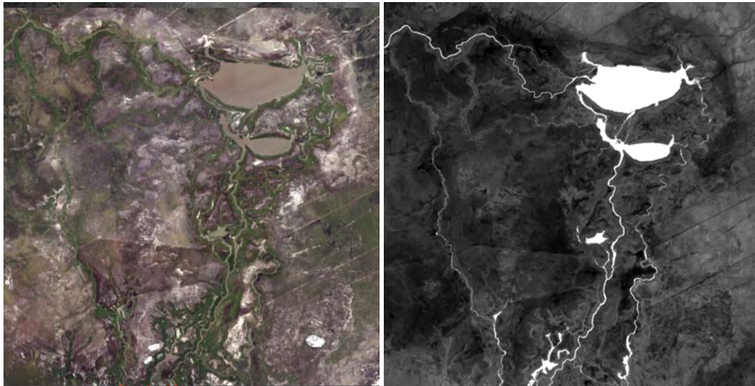
Figura 2: Recorte del mosaico 2013 de la zona “Laguna de los Porongos”, graficado en color real (combinación 432) a la izquierda y procesado y transformado en índice MNDWI a la derecha.
