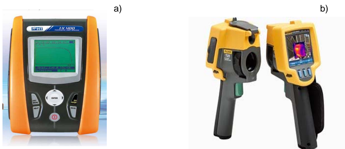
Figura 2.- a) Analizador de curvas I-V, marca HT modelo IV-400. b) Cámara termográfica Fluke TI 25.
