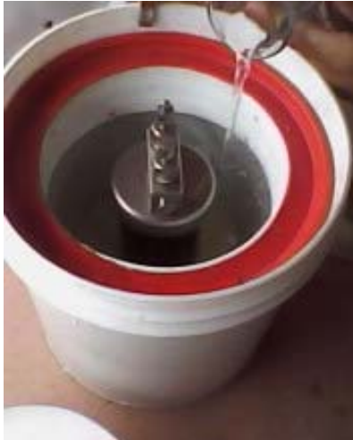
Foto 7: Inmersión de la bomba en agua destilada
