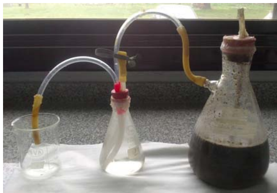
Figura 2: Digestor y sistema de medición de biogás
