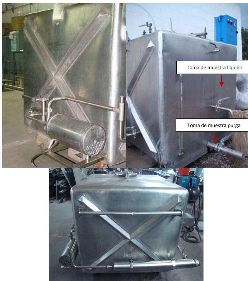
Figura 1: Fotografías del Biodigestor anaeróbico construido a escala piloto (1000 L)
