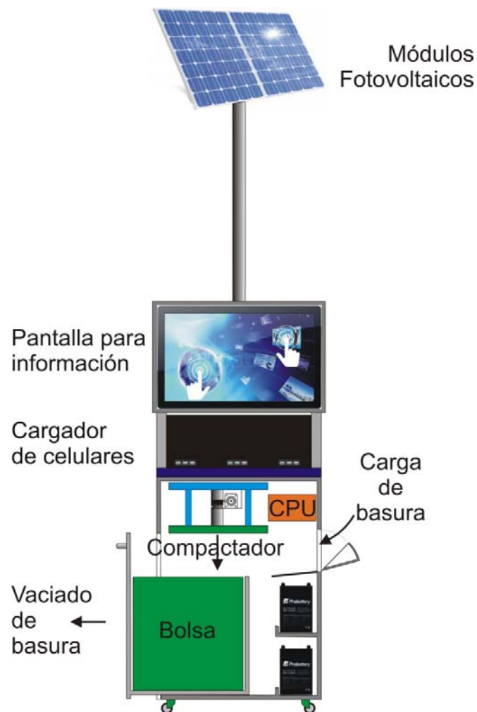
Figura 1. Compactador de basura.
