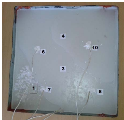
Figura 4: Distribución de las termocuplas en la parafina.
