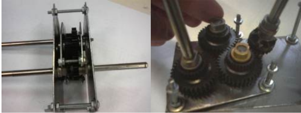
Sistema unificador de giro. (Figura 9)
