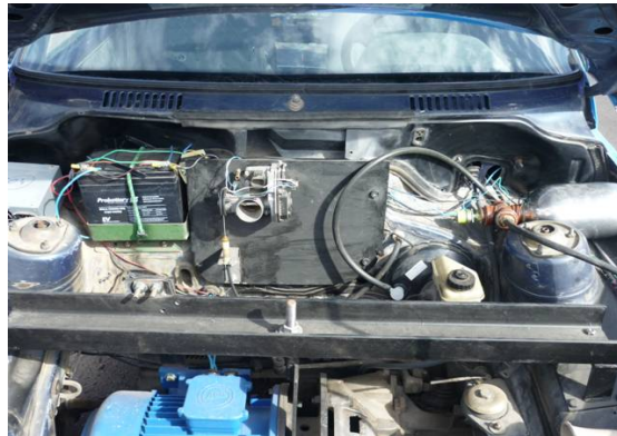
Fig 4-Grupo motor-transmisión Fiat Uno eléctrico
