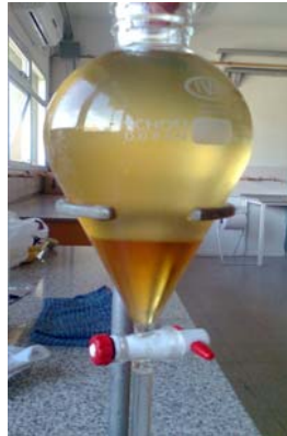
Fig. 4. Ampolla de decantación a los 30 minutos de realizada la carga con la el producto de la mezcla de la reacción de transesterificación
