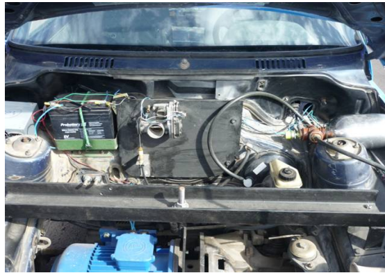
Fig 4-Grupo motor-transmisión Fiat Uno eléctrico
