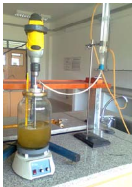
Fig. 1. Sistema frasco reactor para obtención de Biodiesel
