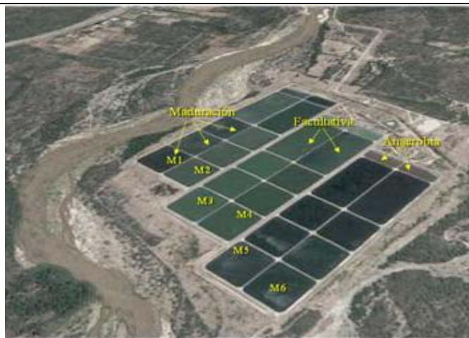
Figura 2. Sistema de lagunas de estabilización de la Ciudad Capital que descarga los efluentes sobre el río Santa Cruz.
