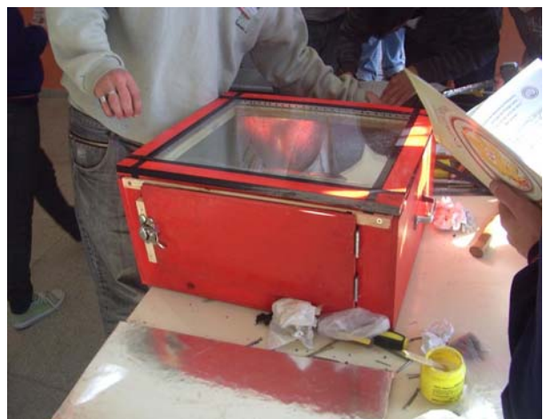
Figura 1. (a) Horno tipo caja modelo Ñacuñán2. (b) Horno de carga vertical desarrollado por el GES.
