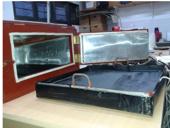
Figura 2: Fotografía parte posterior del horno, puerta de apertura y bandeja con parafina
