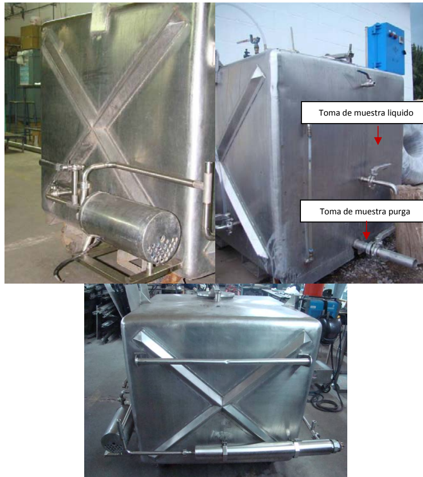
Figura 1: Fotografías del Biodigestor anaeróbico construido a escala piloto (1000 L)
