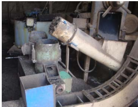
Figura 3. Pelletizadora de tornillo (Gentileza Oleaginosas Olavarría S.A.)
