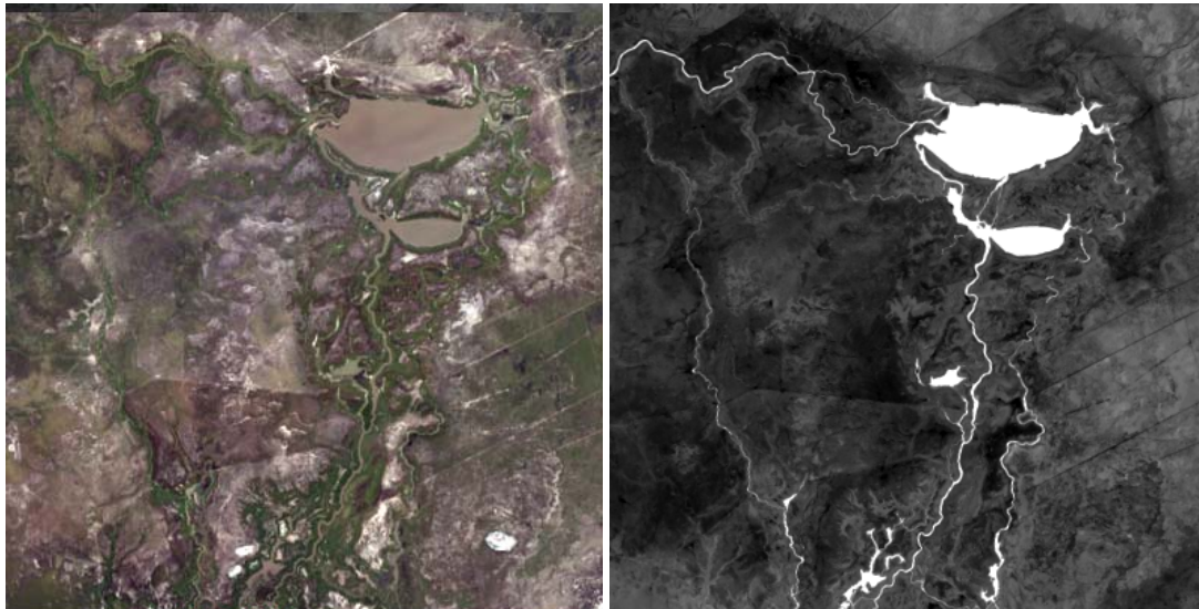
Figura 2: Recorte del mosaico 2013 de la zona “Laguna de los Porongos”, graficado en color real (combinación 432) a la izquierda y procesado y transformado en índice MNDWI a la derecha.
