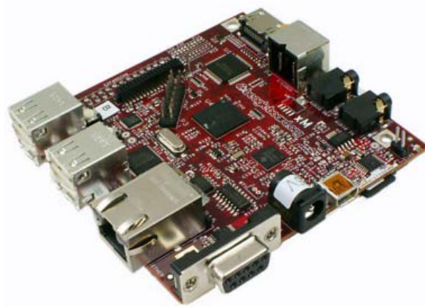
Figura 3. Tarjeta BeagleBoard-XM utilizada como CPU.
