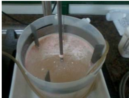
Figura 3. Espuma rosada producida por el crecimiento de la Rhodotorula sp. en un efluente lácteo en el biodigestor.
