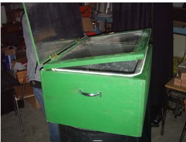
Figura 1. (a) Horno tipo caja modelo Ñacuñán2. (b) Horno de carga vertical desarrollado por el GES.
