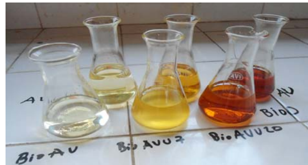
Fig. 4: colores de los biodiesels obtenidos y de los aceites utilizados como materia prima.
