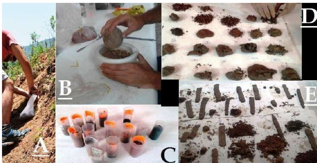
Figura 6.VIII. A) Obtención de las arcillas. B) Machacado. C) Hidratación de los materiales. D) Pruebas de maleabilidad y plasticidad. E) Producción de briquetas experimentales.
