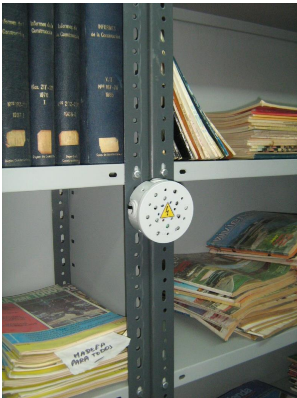
Figura 5: Protección anti vandálica del instrumental. Figure 5: Anti-vandal protection for the instruments.
