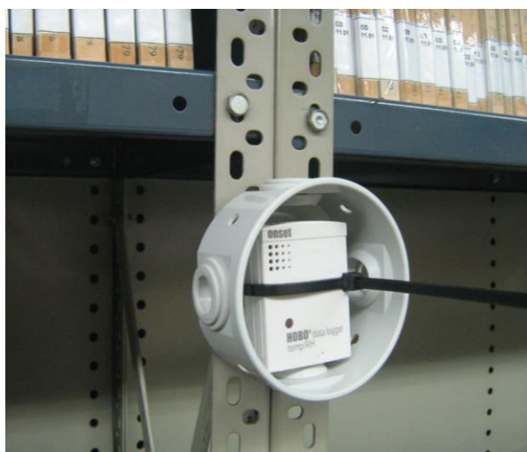
Figura 2: Sensor fijo en estantería. Caso FCE. Figure 2: Sensor attached to a bookshelf. FCE Case.
