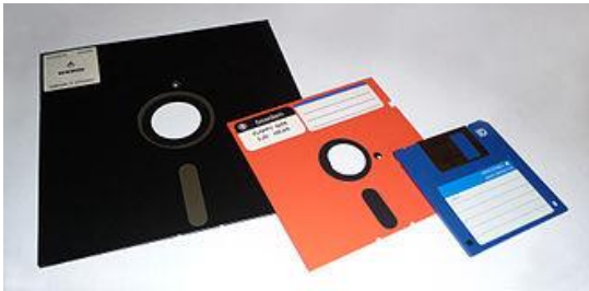
almacenamiento en un dispositivo se lo suele denominar Fig. 10: Diskettes de 8", 5,25" y 3,5"
