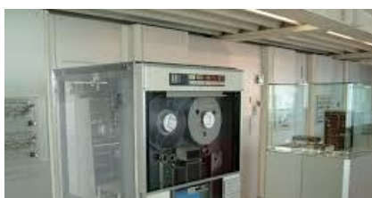
Fig. 9: Foto de una unidad de cinta magnética IBM 729V tomada por mí mismo en el Deutsches Museum de Múnich. Fuente: Wikimedia commons
