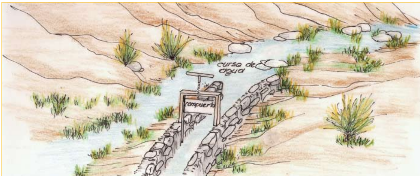
Bocatoma con compuerta de cierre.
