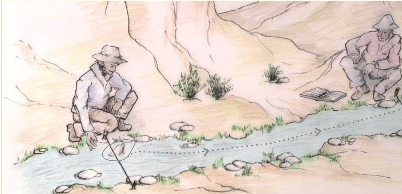
Medición de la velocidad del curso de agua mediante la toma del tiempo en que un flotador recorre una determinada distancia.
