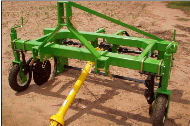
Figura 2. Arrancadora de cebollas AC160, marca Escañuela.
