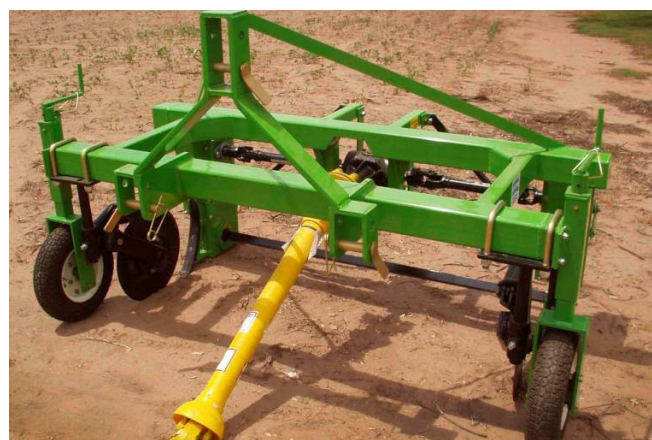
Figura 3. Arrancadora de cebollas AC160, marca Escañuela. Fuente: Brindado por Escagro SRL.
