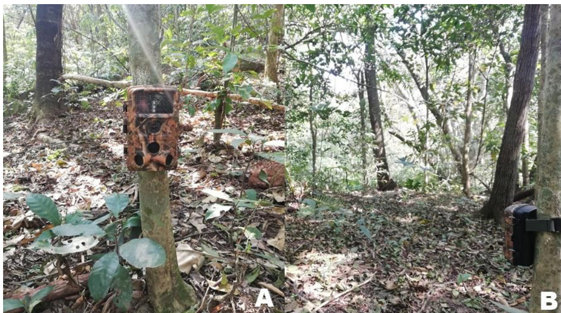
Figura 3: A. Colocación de las cámaras a 30 cm del suelo. B. Cámara ubicada en lugares donde se evidenció la presencia de mamíferos silvestres.
