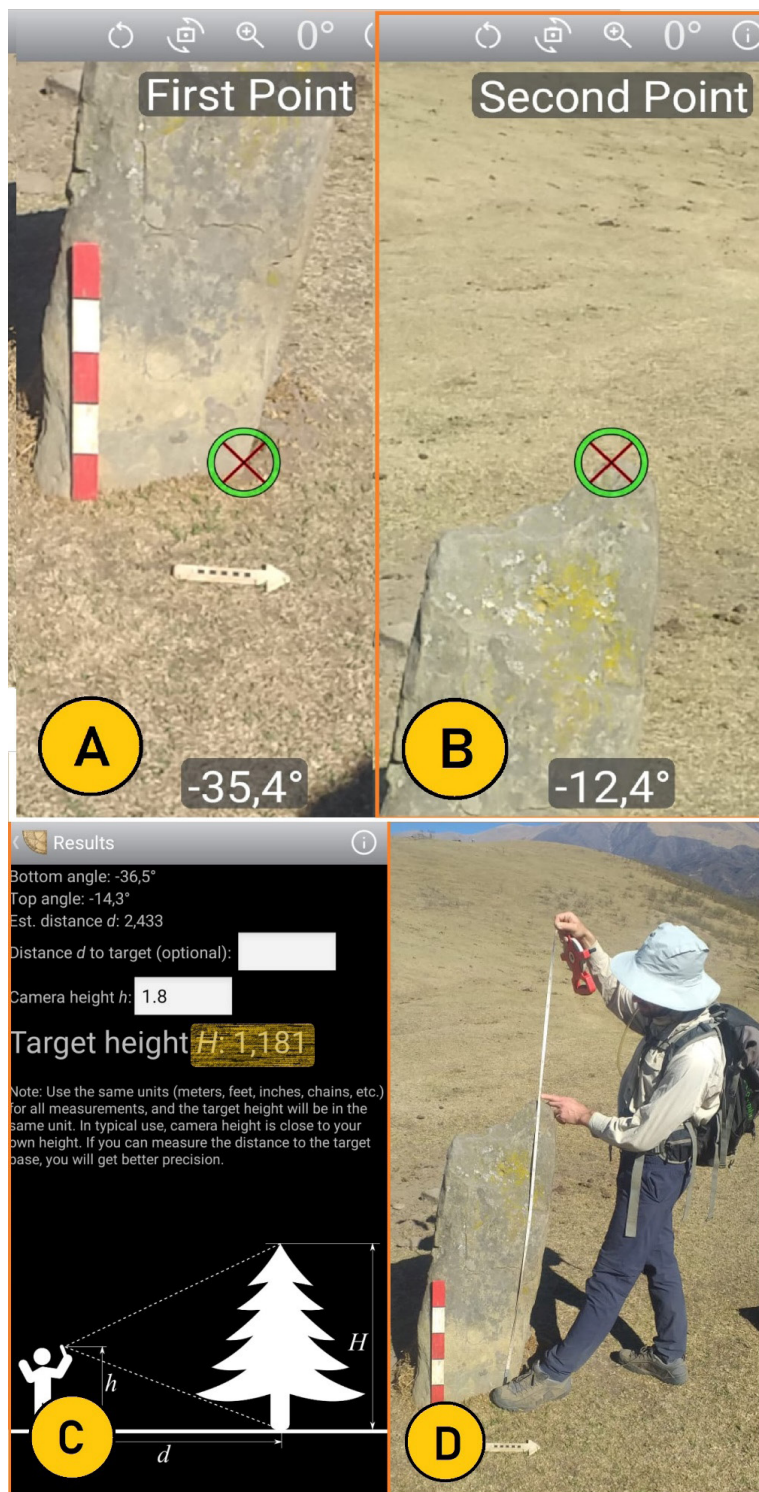
Figura 3. Ejemplo de uso de Two point height. a) Toma de punto de referencia 1 (visión en la interfaz de la app); b) Toma de punto de referencia 2; c) Altura calculada (en recuadro); d) Corroboración de medida de app contra cinta métrica.
