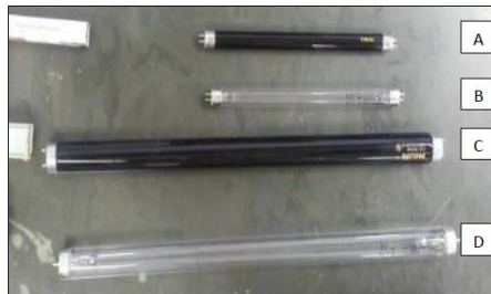
Figura 3. Lâmpadas: negra 15 W (A), germicida 15 W (B), negra 30 W (C) e germicida 30 W (D).
