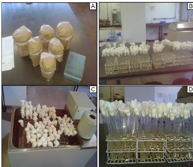
Figura 5. Preparação do meio de cultura, onde: A = tubos com meio de cultura prontos para autoclavar; B = tubos autoclavados e prontos para iniciar as diluições; C = tubos em banho maria; D = teste finalizado.
