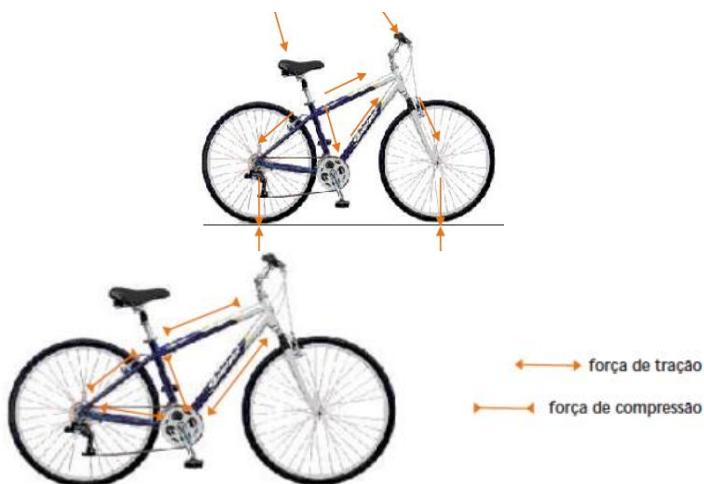
FIGURA 11: Transferência de carga e forças atuantes no quadro de uma bicicleta. FONTE: MEDEIROS, 2003.
