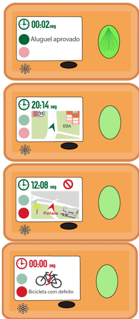
FIGURA 56: Escopo do funcionamento do componente eletrônico. 1- liberação do aluguel; 2- GPS e controle do tempo de aluguel durante o percurso; 3- alarme antifurto, ultrapassando os limites permitidos; 4- Sinalização de bicicleta com defeito.
