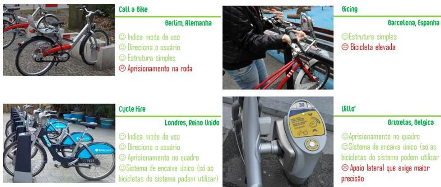
FIGURA 35: Análise de quatro sistemas similares nos aspectos de trava e apoio das bicicletas.
