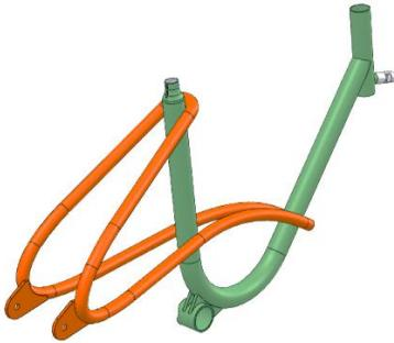
O material selecionado para o quadro do projeto são os tubos de aço, liga metálica formada essencialmente de ferro e outros elementos adicionais, tradicionalmente aplicado a bicicletas por sua alta soldabilidade, resistência, elevada absorção de impactos mecânicos sem deformação permanente, e conformabilidade (MEDEIROS, 2003). Além disso, os tubos de aço têm baixo custo e exigem apenas uma tecnologia
