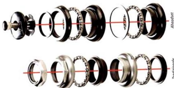
FIGURA 12: Diferentes modelos de caixa de direção. FONTE: BALLOCCHI, 2012.
