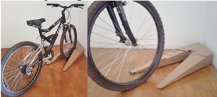
FIGURA 39: Mock-up volumétrico em material alternativo 1:1 de um guia de chão.
