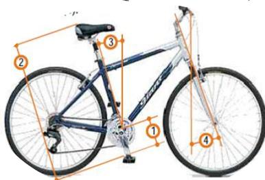
FIGURA 13: Principais variáveis da geometria de uma bicicleta. FONTE: MEDEIROS, 2003.
