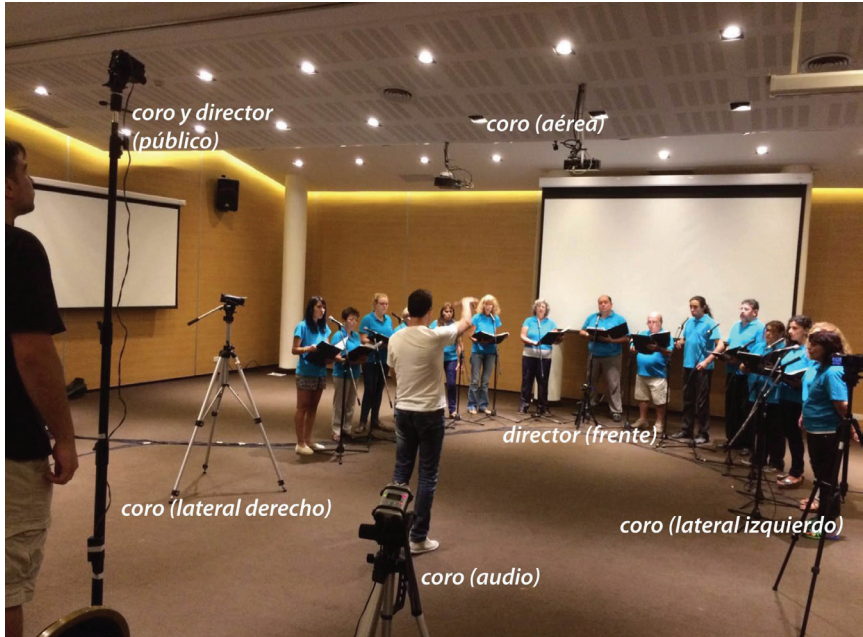
Figura 2. Instalación de la situación experimental con las referencias de los registros de audio digital y cámaras de video digital obtenidos en la captura.
