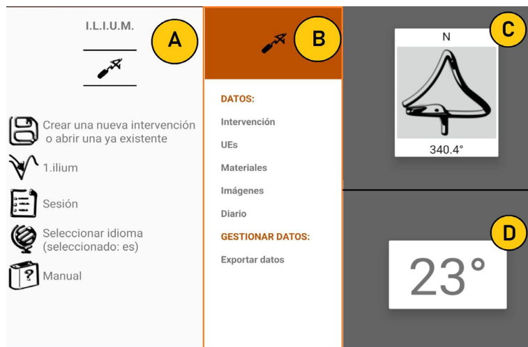
Figura 1. Interfaz de I.L.I.U.M. A) Pantalla de inicio. B) Sub-menú de carga de distintos datos. C) Brújula integrada. D) Nivel integrado.
