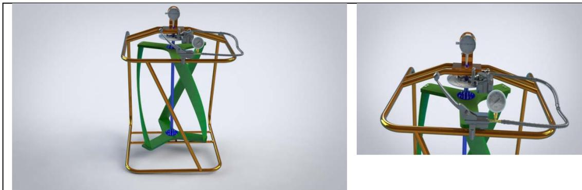
Figura 1. Modelo de Turbina Gorlov e instrumental de mediciones. Fuente: Marcano y otros. “Desarrollo de un Modelo Experimental de Turbina Hidrocinética Tipo Gorlov”. Tesis en elaboración. IUTEB.
