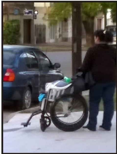
Fig.3: Silla plástica adaptada como asiento en una silla de ruedas.
