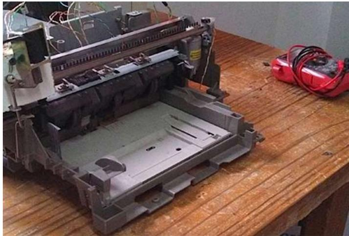
Figura 1. Primer prototipo de impresora braille (Openbraille, 2014)
