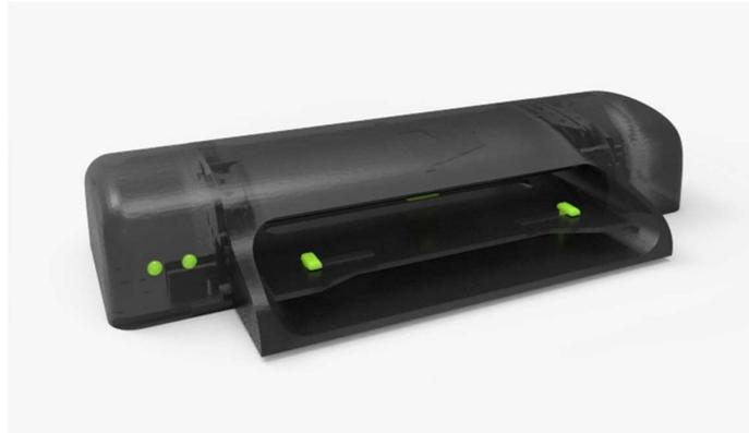
**Figura 4. Impresora braille de bajo costo con componentes reciclados**
