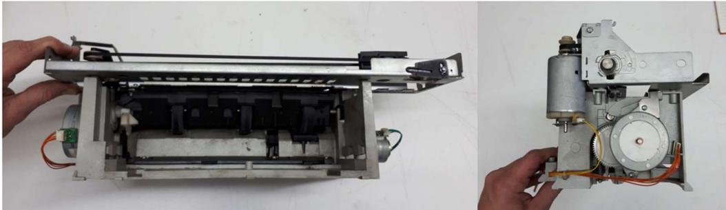
Figura 2. Estructura y paquete electromecánico reciclado de impresora inkjet
