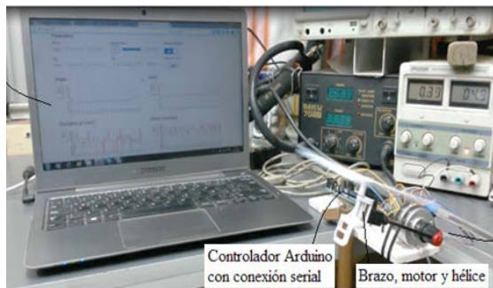
Figura 2. a) Conexión de ROS al sistema físico. (Fuente: Elaboración Propia)
