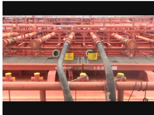
Figura 35: Mangueras cargando aceite en barco.
