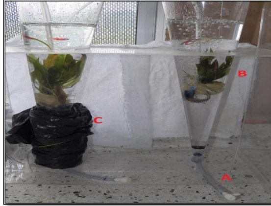
Figura 4. Acuarios tipo cono HIMOF, A. Adaptación para recolecta de huevos, B. Enriquecimiento ambiental y sistema de oxigenación, C. zona de oscuridad del acuario.
