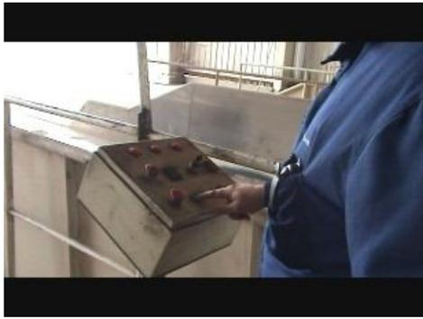
Imagen 3: Tablero para manejar la plataforma volcadora de acoplados
