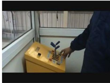
Imagen 4: Tablero para manejar el calador neumático
