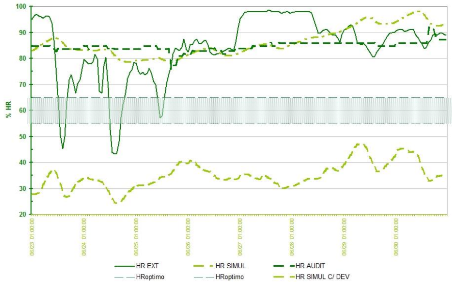
Figura 8: Humedad relativa en el transcurso del período estudiado para datos exteriores, de auditoría, simulados en las condiciones actuales y simulados con DEV.
