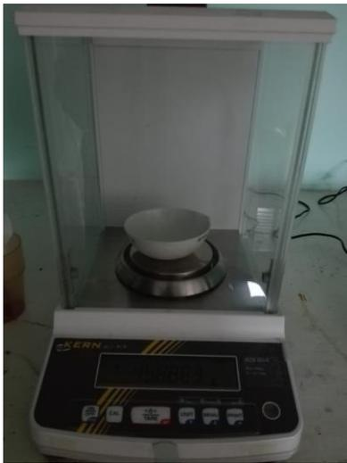
Figura 18: Pesaje de crisol en balanza digital, laboratorio de Genética
