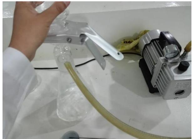
Figura 14: Bomba de vacío para filtración de Coliformes fecales
