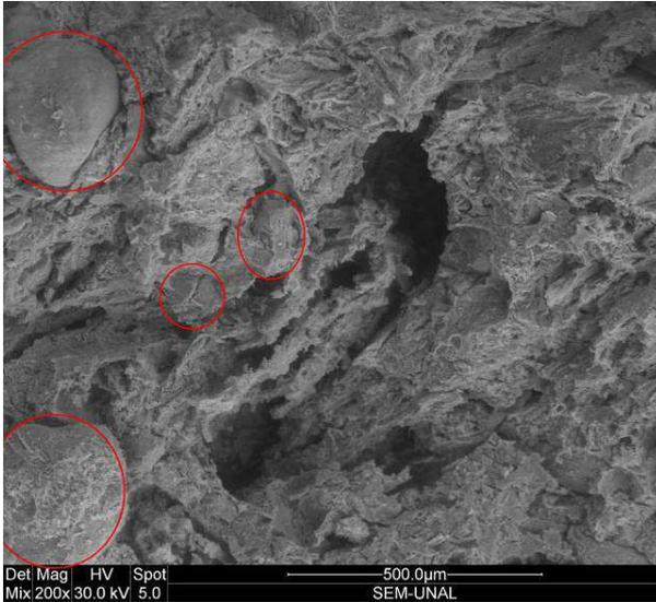
**Fig.13** Micrografía de la muestra preparada con la mezcla de concentración de aserrín ( $11.4 \pm 0.1$ ) % m/m
