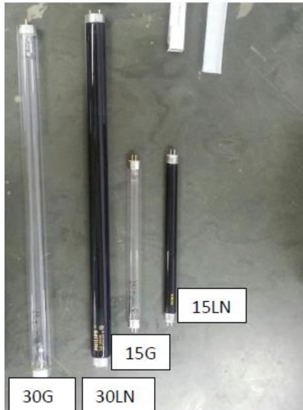
Figura 03: Onde: 15LN = lâmpada de luz negra 15 W; 15G = lâmpada germicida 15 W; 30LN = lâmpada de luz negra 30 W; 30G = lâmpada germicida 30 W.
