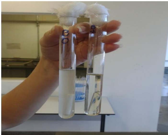
Figura 07: Tubos de ensaio contendo meio de cultura. À esquerda tubo com a presença de coliformes termotolerantes (presença de gás e turvação). À direita, tubo com meio de cultura sem indicativo de contaminação.
