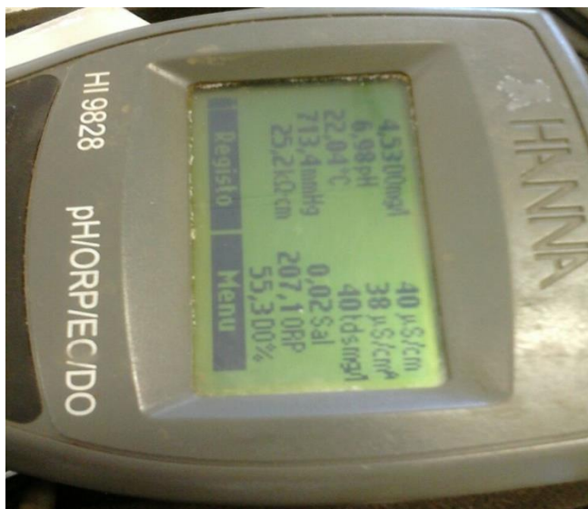
Figura 06: Sonda Multiparâmetro HANNA HI9828 com os resultados da primeira etapa.
