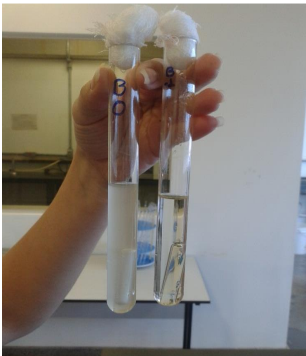
Figura 2. Imagem a esquerda mostra meio de cultura com turvação, indicativa de presença de coliformes termotolerantes, contrastando com o tubo a direita, sem a presença de turvação.
