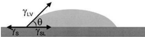
Figura 7: Definição de ângulo de contato e tensões superficiais presentes na equação de Young. Fonte: Burkarter,2010.
