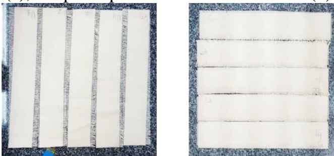
FIGURA 24 – Corpo de prova no sentido do urdume (a), Corpo de prova no sentido da trama (b)
