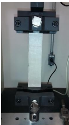
FIGURA 37 – Posicionamento da tira (a), Rompimento da tira (b)
