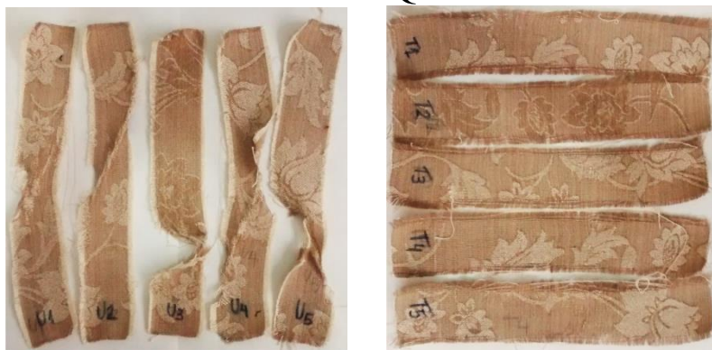
FIGURA 30 – Rupturas obtidas, sentido urdume e trama do JACQUARD.
