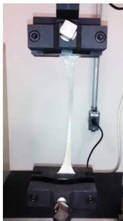
FIGURA 34 – Alongamento sentido vertical
