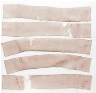
FIGURA 38 – Ruptura sentido único do SUED
