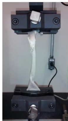
FIGURA 37 – Posicionamento da tira (a), Rompimento da tira (b)
