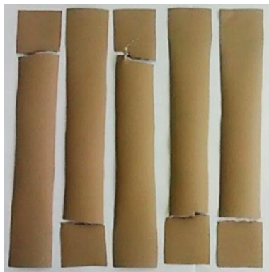
FIGURA 41 – Ruptura sentido único do COURÍSSIMO.
