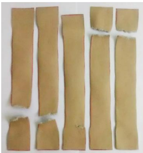
FIGURA 44– Ruptura sentido único do COURO.
