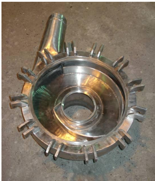
Figura 2: Interior voluta bomba 40 HP para jugo de tomate a 21° Brix Fuente Rubio y Asociados
