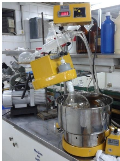
Figura 3. Evaporador rotativo a presión reducida (Rotavapor Fbr® Decalab S.R.L., MERCOSUR).
