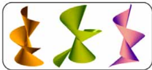
Figura 7. Exploración de superficies tangenciales a partir de la hélice cónica.
