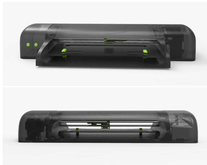
Figura 5. Vistas frontal y trasera de la Impresora braille de bajo costo Figure 5. Front and back views of the low cost braille printer
