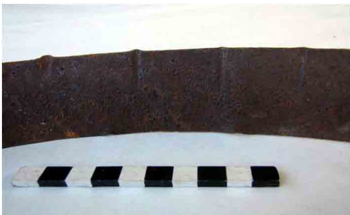
FIG. 84. Fleje cortado en maquinaria pero trabajado de un lado mediante golpes, para darle la curvatura alabeada del barril
