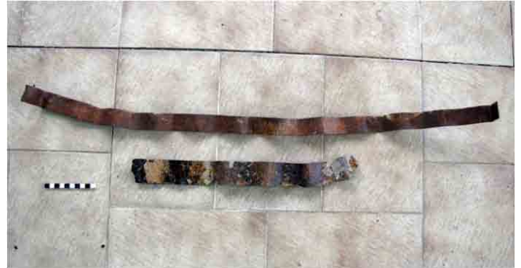
FIG. 94. Láminas alargadas con la forma de las chapas acanaladas de zinc usadas en techos para ayudar a sostenerlos ante el viento
