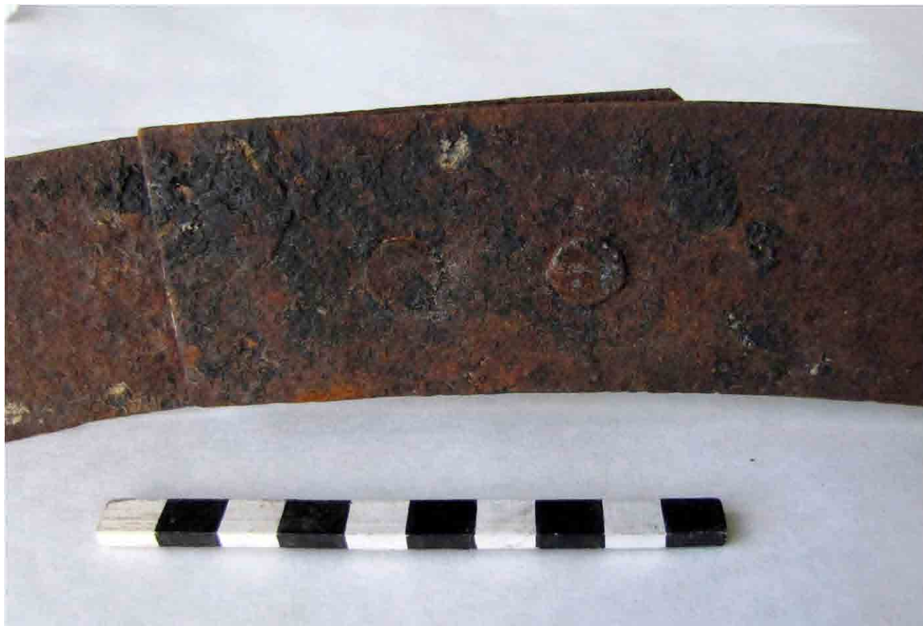
FIG. 88. Fleje cerrado con dos cabezas de clavos redondos de producción industrial que aun conservan las marcas de su manufactura; nótese que los cortes finales son oblicuos
