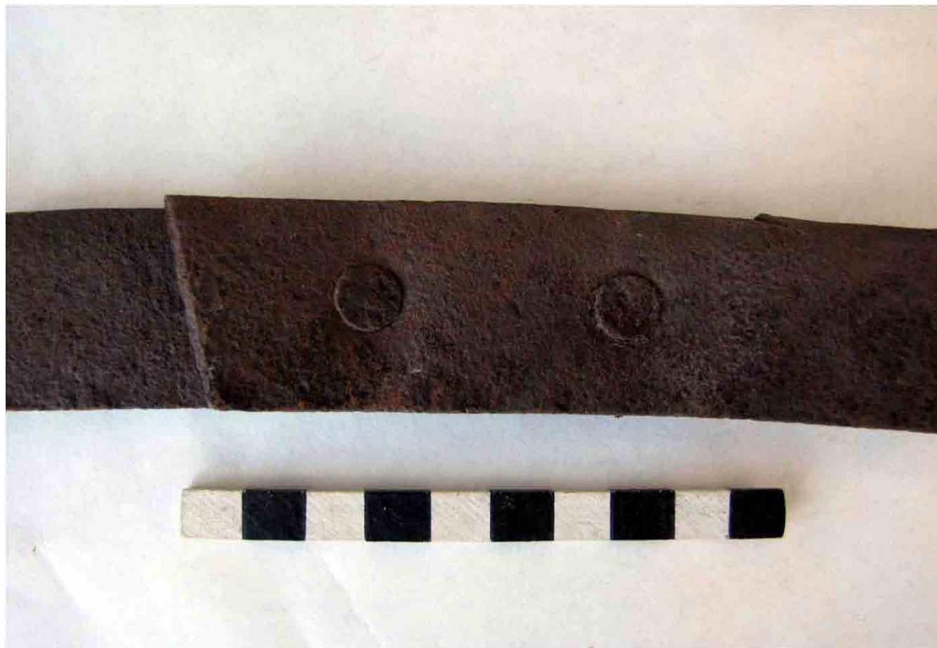
FIG. 92. Otro ejemplo producido en máquina, unido por dos remaches circulares con el borde cortado de manera irregular
