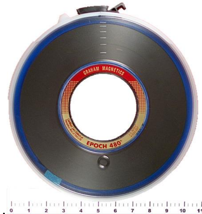
Imagen 5. Cinta Magnética de 9 pistas, carretel de 10.5 pulgadas y 1/2 pulgada de espesor
