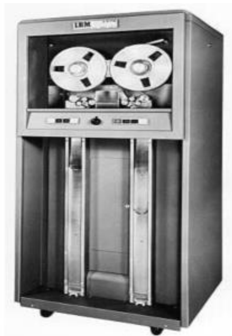
Imagen 3. IBM 727. Unidad de Cinta Magnética de 7 pistas
