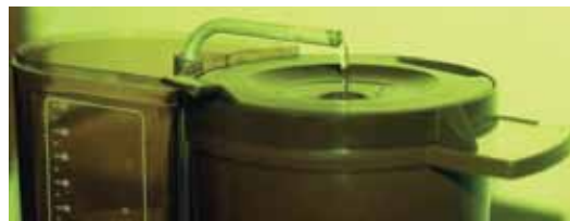
Fig. 7 - Movimento da água pelo tubo após aquecida
