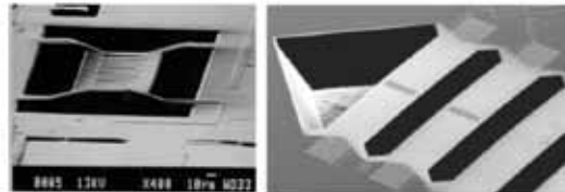
FIGURA 13: Sensores infravermelhos CMOS - (a) bolômetro e (b) termopilha
