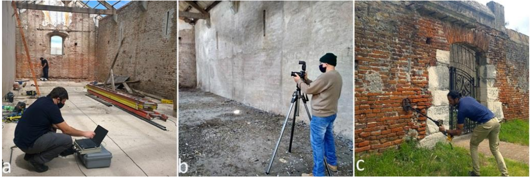
Figura 17. Uso de distintas tecnologías de prospección; a) georradar; b) fotogrametría; c) detector de metales. Fuente: Archivo de los autores.
