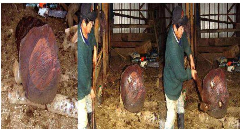
Figura 6. Inicio del procedimiento de construcción de la batea. De izquierda a derecha: 6.1 El tronco se prepara para el trabajo; 6.2 se sitúa una cuña metálica en una grieta o «viento» del tronco donde Don Ernesto golpea con un combo; 6.3 la grieta se expande y se coloca una segunda cuña metálica.
