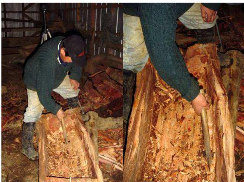
Figura 15. El retoque final se realiza con una azuela de mano, más pequeña, llegando a un adelgazamiento máximo del piso de la batea, y cuidando de no romperlo. En la secuencia se observa de izquierda a derecha: 15.1 Don Ernesto maneja la azuela de mano en los retoques finales; 15.2 detalle del uso de la azuela de mano sobre la batea.
