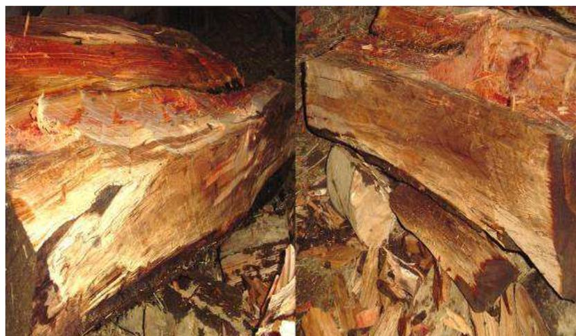
Figura 10. Descortezamiento del tronco. Antes de continuar con el ahuecamiento del tronco Don Ernesto procede a descortezarlo por los costados, proceso para el cual sigue utilizando el hacha, dejando claras huellas de corte en los costados de la batea. En la secuencia se aprecian estas marcas desde dos vistas distintas, marcas que son claramente diferenciables de las anteriores.
