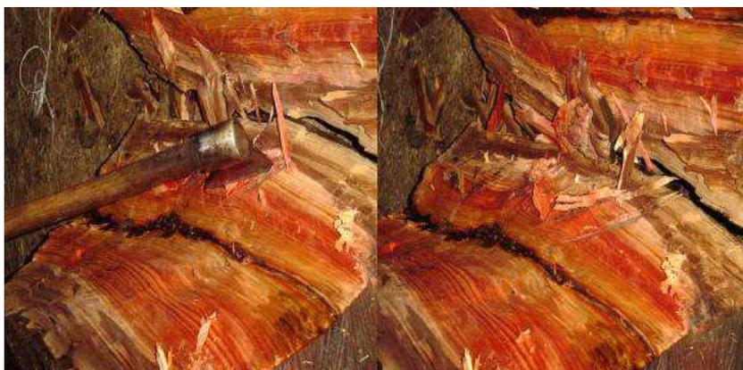
Figura 8. Comienza el trabajo de rebaje en una de las mitades del tronco. Este trabajo se realiza principalmente con el hacha, y lo que se intenta es ir extrayendo la mayor cantidad de madera del tronco para ir ahuecándolo. De izquierda a derecha: 8.1 el hacha golpea el tronco extrayendo parte de su superficie; 8.2 huella de corte que deja el hacha sobre el tronco.
