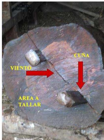
Fig. 4. Pieza de coihue para tallado de batea, se observa apertura de vientos y área a tallar.
