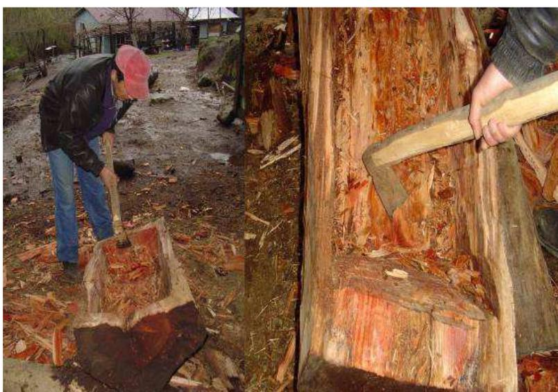
Figura 13. Una vez extraída la mayor parte de la madera se continúa el trabajo de retoque con la azuela, logrando un adelgazamiento de las paredes. Esta se introduce en forma transversal al tronco ya que su filo forma un ángulo recto con el empuñe. De izquierda a derecha observamos: 13.1 el ayudante de Don Ernesto comienza el trabajo de retoque con la azuela; 13.2 detalle de cómo se introduce la azuela en el tronco, siendo muy distinta a la posición del hacha.
