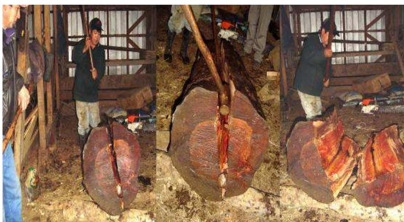
Figura 7. Secuencia de rajadura del tronco. De izquierda a derecha: 7.1 y 7.2 el tronco está casi partido y solo se requiere introducir el combo en la grieta para que termine de partirse; 7.3 el tronco se ha rajado en dos mitades casi perfectas.
