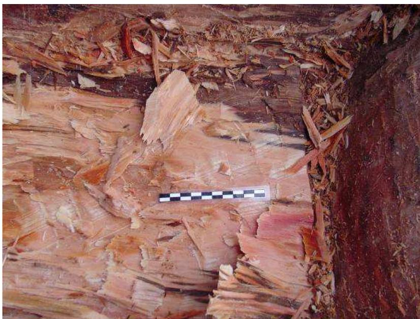
Figura 14. Detalle de las huellas que deja la azuela sobre la madera. Son muy diferentes a las del hacha, ya que el filo de la herramienta levanta la madera en la zona en que se introduce para luego arrancarla por la fuerza que ejerce, rasgándose. La marca del corte es pequeña como consecuencia, pero es evidente el rasgamiento que se produce.
