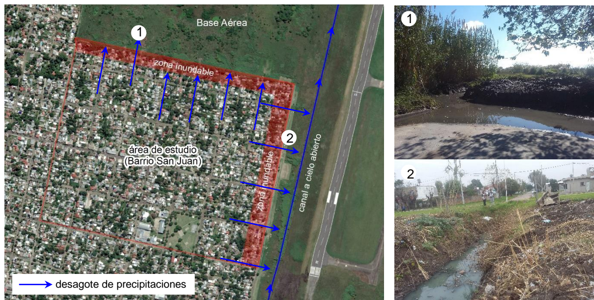
Figura 6. Desagües pluviales y zonas inundables
